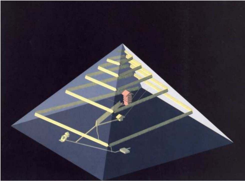
Abb. 7.4.7.2 Vorschlag einer Integralrampe (Tunnelrampe) nach Houdin
